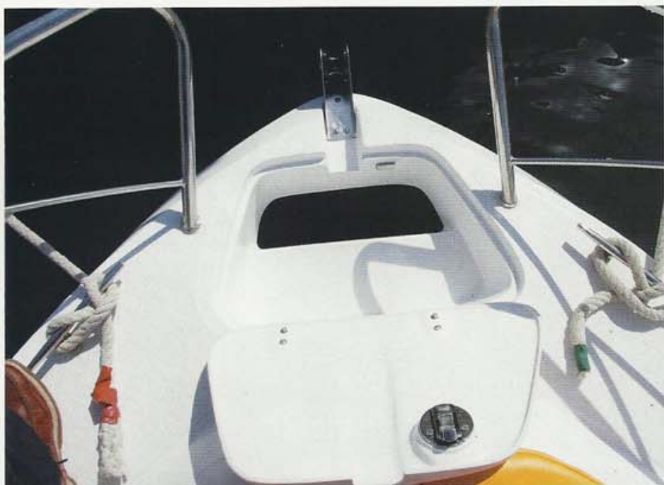
Una base permite montar un molinete en el interior del cofre de anclas.
