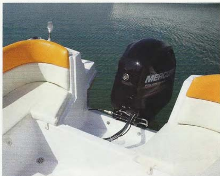
Asiento y respaldo se desmonta para acceder al motor y permitir su completa elevación.
