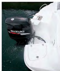
El hecho de que se equipe con un motor fueraborda hace que la plataforma de baño se vea dividida en dos más pequeñas, una a cada banda, y que tenga el motor instalado en la prebañera.
